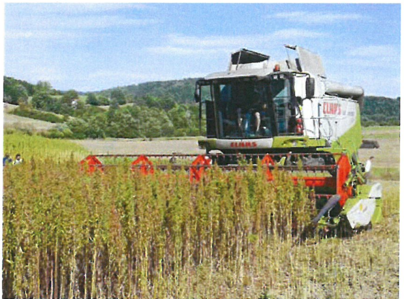
Karl-Friedrich Theune beerntete mit dem betriebseigenen Schüttlermähdrescher die reife Ölhanfsorte Finola auf der Demofläche. Um Störungen zu vermeiden, konnte Theune nur langsam fahren. Fotos: Dr. Hildebrandt
