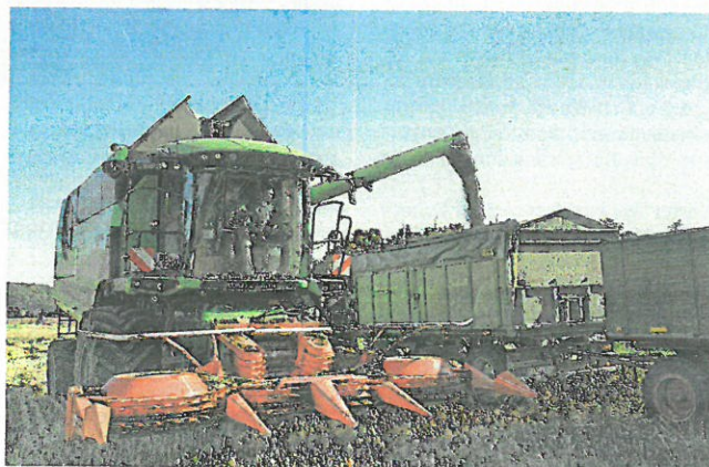
Der spezielle Hanfdrescher ist mit einem Maisgebiss ausgerüstet.
