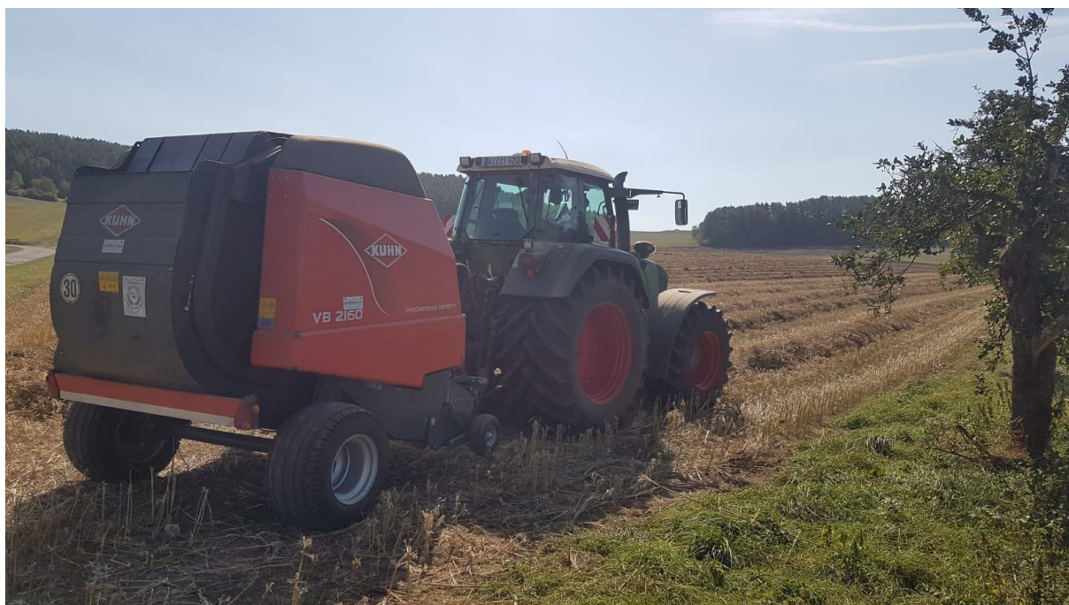
Abbildung 2: Hanfstrohpresse im Einsatz OG Hanfanbauer Werra-Meißner (2020)
